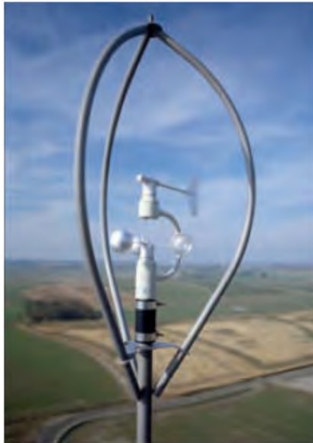
12 pav. Vėjo jėgainės vėjo sensorius (meteostotis)
