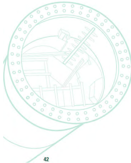
5 pav. Apatinė bokšto sekcija, tvirtinama į pamatą
