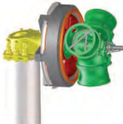
9 pav. Vienos pavaros rotorius su generatoriumi
